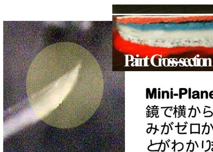
Mini-Planeで削り取った試料を顕微鏡で横から見た画像です。試料の厚みがゼロから徐々に厚くなっていることがわかります。
