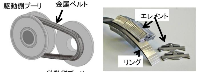
図8 ベルト式CVTの原理
