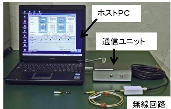
図4 データロガーの収録システム
