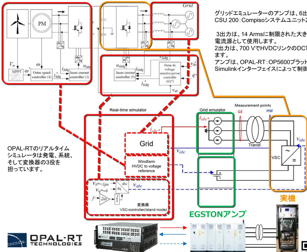
カタログ裏面の装置を用いて上記の様な試験環境を構築しました
